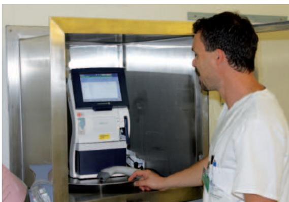
*Buchstäblich ein Labor in der Box ist diese Schleusenkonstruktion zwischen OP-Bereich und Aufwachraum. Das BGA-Gerät steht auf einem Drehteller in einem in die Wand eingelassenen Edelstahlkasten und kann wechselseitig von beiden Seiten bedient werden. Bildquelle: Dr. Michael Gruber.*
