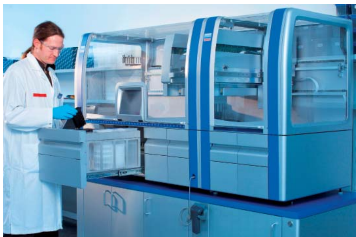
Automatisierte Durchführung von PCR-Tests auf dem QIASymphony RGQ.
