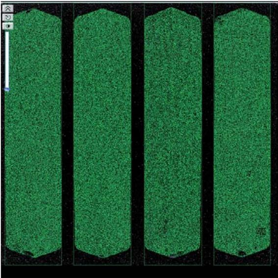
Picotiterplatte (PTP) des GS FLX: Die an Beads gebundenen DNA-Fragmente werden monoklonal amplifiziert und auf eine Reaktionsplatte (PTP) geladen. In diesem Beispiel wurden vier getrennte Kompartimente verwendet. Pro Sektor konnten ca. 130 MB Sequenzdaten generiert werden (Bild: MPI, Berlin).
