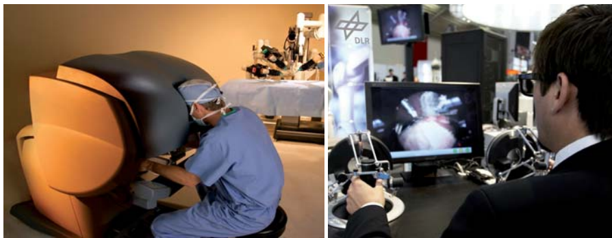
Das da Vinci System (links) befindet sich bereits im Einsatz, MiroSurge ist als Prototyp verfügbar. 3D-Bildschirm und ergonomische Telemanipulatoren erlauben hier ein entspannteres Arbeiten.
