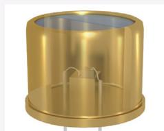
**Avalanche-Photodiode.** Das Durchflusszytometer Dx FLEX verwendet anstelle von Photomultipliern Avalanche-Photodiode-Detektoren. Durch die Reduktion des elektronischen Rauschens auf ein Minimum ist das Auflösungsvermögen des Gerätes besonders hoch.
