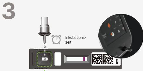
Nachdem Sie die Probe auf die Testkassette gegeben haben, inkubieren Sie diese außerhalb des Analysegerätes. **Sobald die Inkubationszeit abgelaufen ist, setzen Sie die Testkassette in den Analyzer ein.**
