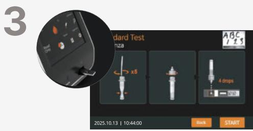
Sobald eine neue Testkassette eingesetzt wird, wird die entsprechende Testmethode auf dem Bildschirm angezeigt. Befolgen Sie die Anweisungen auf dem Bildschirm, um die Probe zu dosieren, und **berühren Sie die Taste „START“**.
