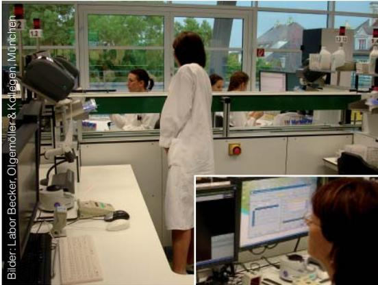
„Laborstraßen“ sind Förderbänder, die voll- oder halb-automatische Workcells sowie IT-gestützte manuelle Arbeitsplätze (kleines Bild) miteinander verbinden. Nach der Bearbeitung werden die Agarplatten auf das Band gelegt und weiter transportiert.
