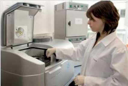
Vermessung prozessierter Microarrays mit Agilent Hochleistungsscanner (2µm Auflösung).
