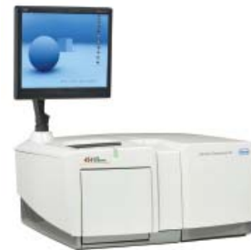
Das Genome Sequencer 20 System erreicht eine Sequenzierleistung von mind. 20 Mio. Basen in einem einzigen fünfständigen Durchgang. Er ist damit etwa 60 mal schneller als die herkömmliche Sanger-Methode.
