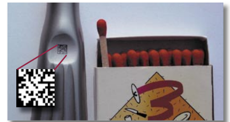
Nicht viel größer als ein Streichholzkopf: Identifikation medizinischer Instrumente mit einem 2-dimensionalen Punktcode.
